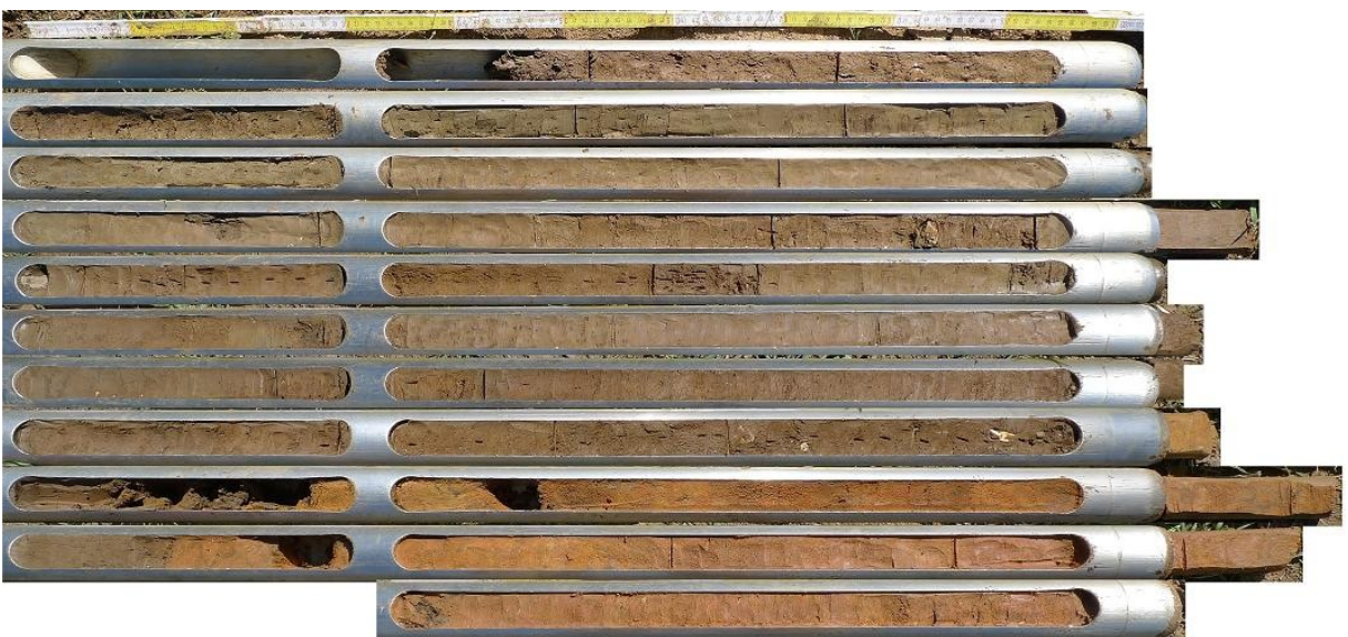
Anhang 3: Foto der einzelnen Bohrmeter des Bohrkerns 7
