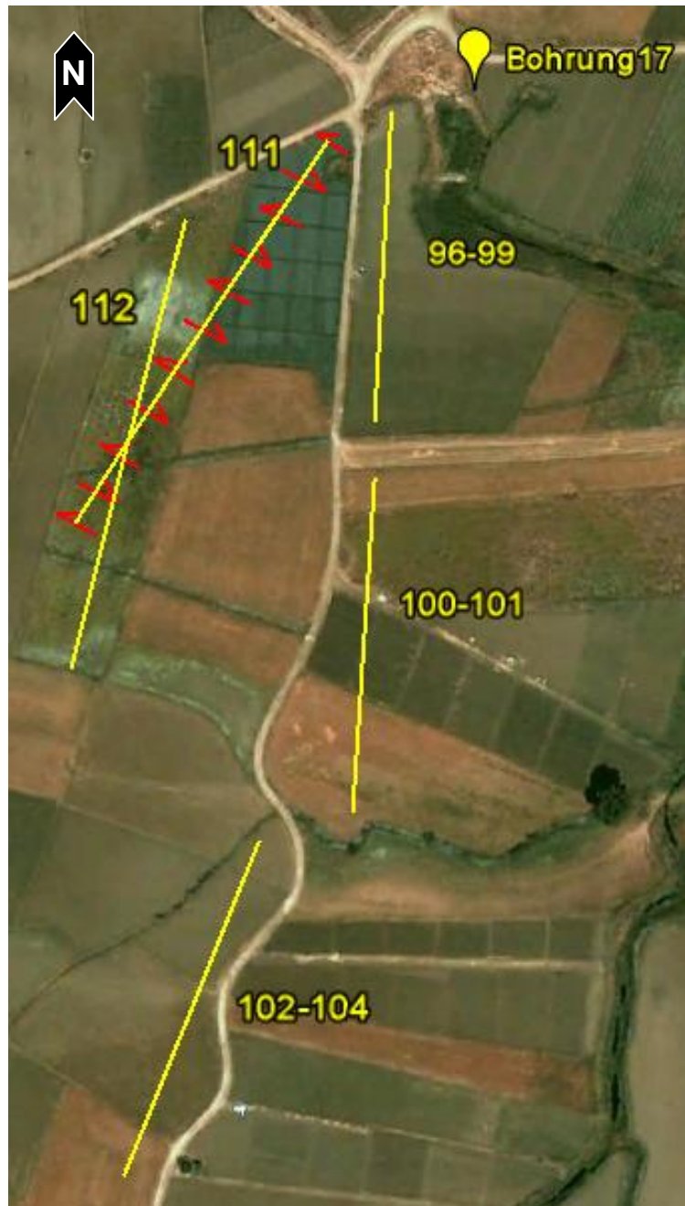
Abb. 11 Übersicht über die Lage der Geoelektrik- und Radarprofile sowie der Rammkernsondierung, aus: Google Earth
