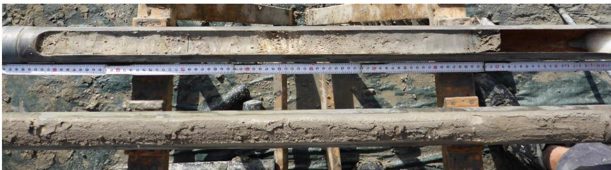
**Abbildung 6:** Mit Sediment gefüllte Sonden nach offenen Bohrungen. Oberer Bohrkern zur Sedimentansprache präpariert. Photo aus von Harten, 2014 (unveröffentlicht) von Tabea Schröder.
