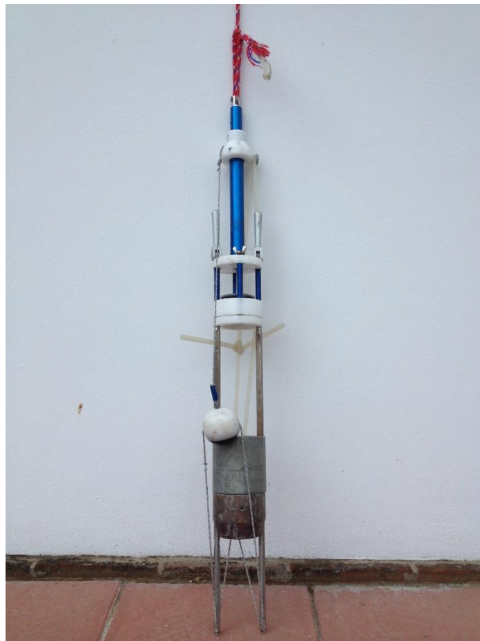
Abbildung 11: Schwerelot welches bei der Probenahme in der Laguna de Medina verwendet wurde. Quelle: Eigenes Foto
