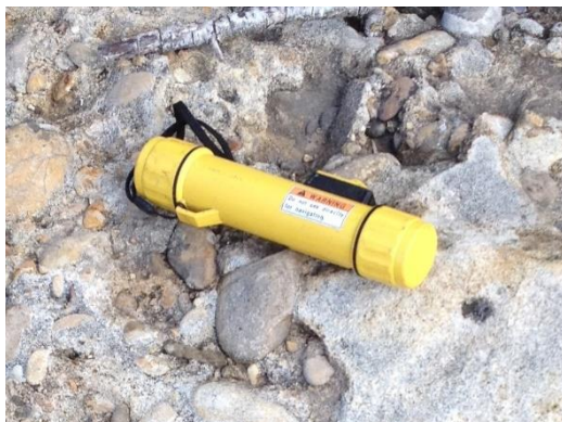
Abbildung 15: Das bei den Untersuchungen in der Laguna de Medina verwendete Hand-Echolot "ECHOTEST II". Quelle: Eigenes Foto
