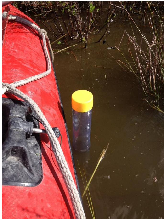
Abbildung 13: Im Seesediment steckender Liner. Die gelbe Kappe sorgt für einen Unterdruck, welcher verhindert, dass das Sediment im Boden stecken bleibt.
