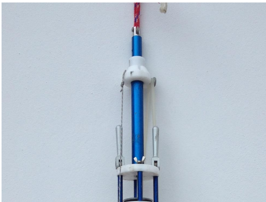
Abbildung 12: Detailansicht des Schwerelots. Links ist das an dem Haken befestigte Seil zu erkennen. Auf der rechten Seite des blauen Stahlrohrs ist das unter Spannung stehende Gummiband zu sehen. Quelle: Eigenes Foto
