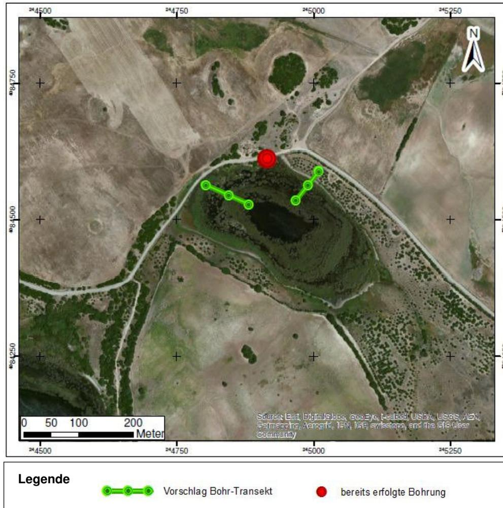
**Abb. 16:** Orthografische Auswertung der Laguna de Hondilla hinsichtlich potentieller Bohrlösungen in Form von Bohr-Transekten (Nr. 4-5 von W nach E).
