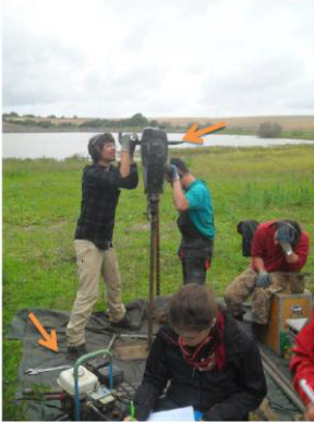
Abb. 6: Durchführung einer Rammkernsondierung
