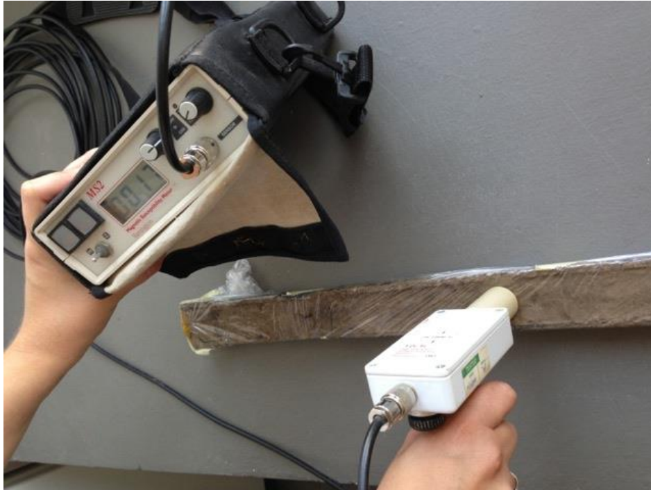
Abb. 8: Messen der magnetischen Suszeptibilität im Labor.
