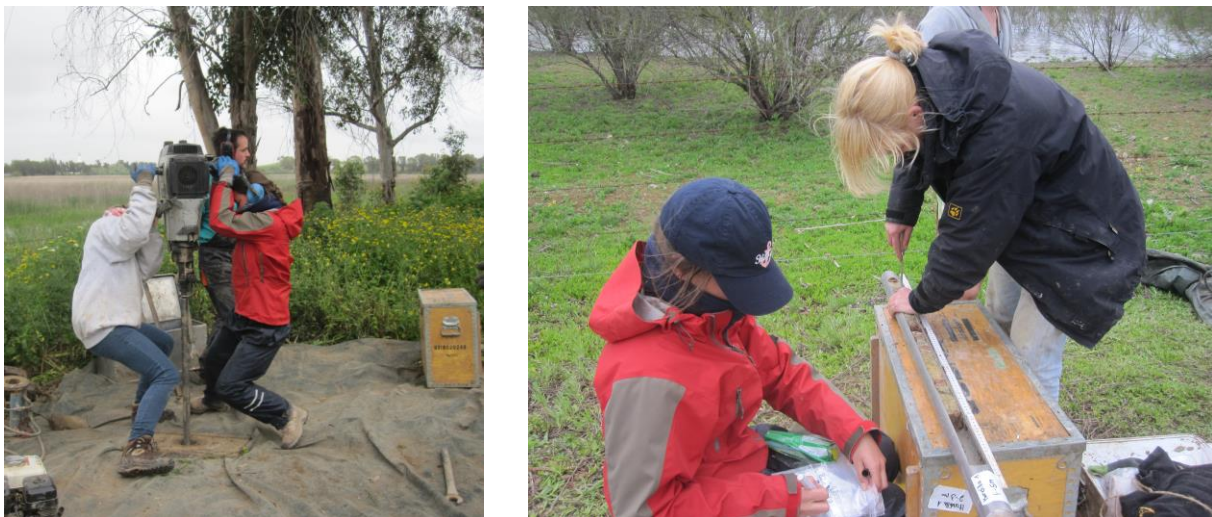
Abb. 7: Rammbohrung (links) und Entnahme von Proben aus einer Schlitz-Sonde (rechts).
